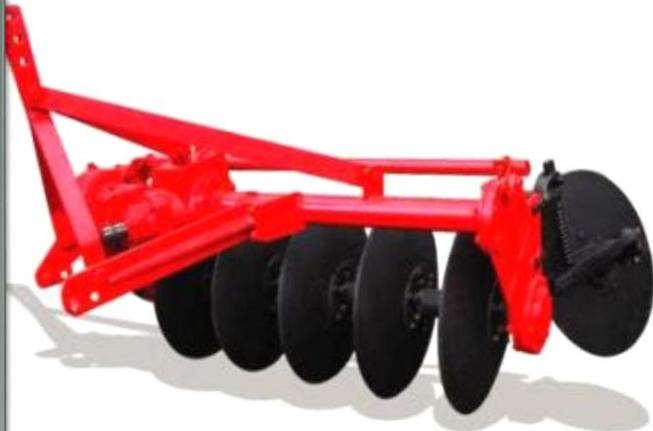
L'aratro a disco è utile per tagliare l'erba, la paglia o campi con steli di piante. Facile da utilizzare, viene montato con il trattore, e la funzione dei dischi è quella di modificare il terreno. Questo particolare modello si presta soprattutto per l'aratura risaia e ha un'alta qualità operativa e un'alta produttività lavorativa.
